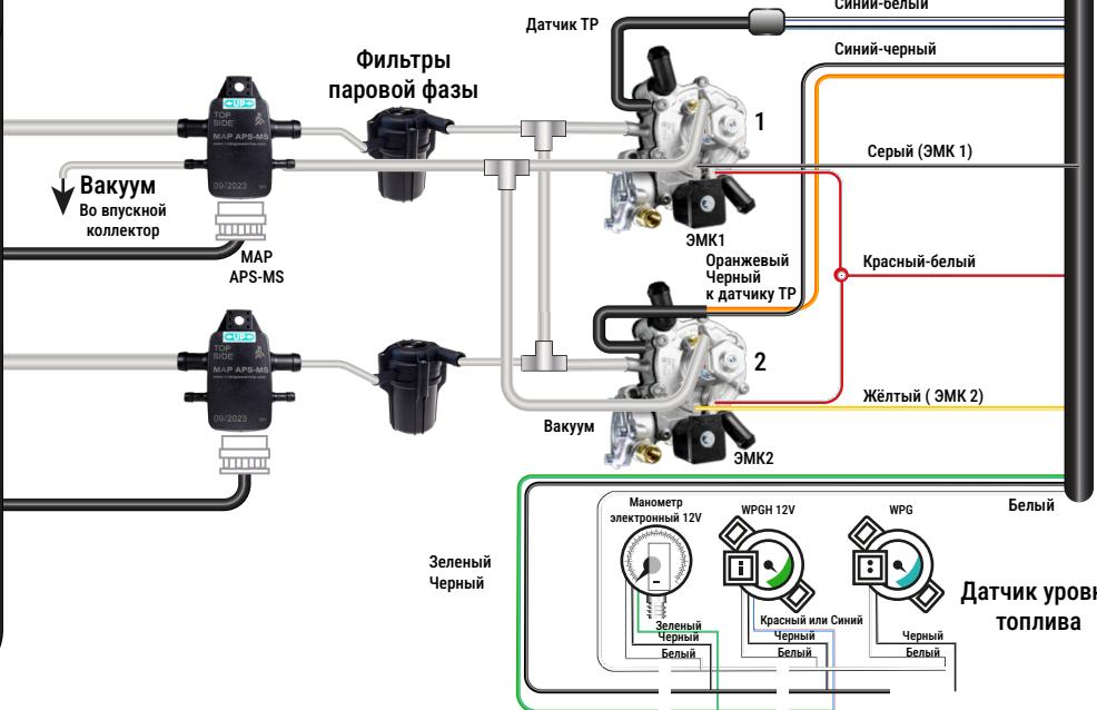
**МОНТАЖНАЯ СХЕМА ALPHA MS-8-V8. 2 Редуктора**
