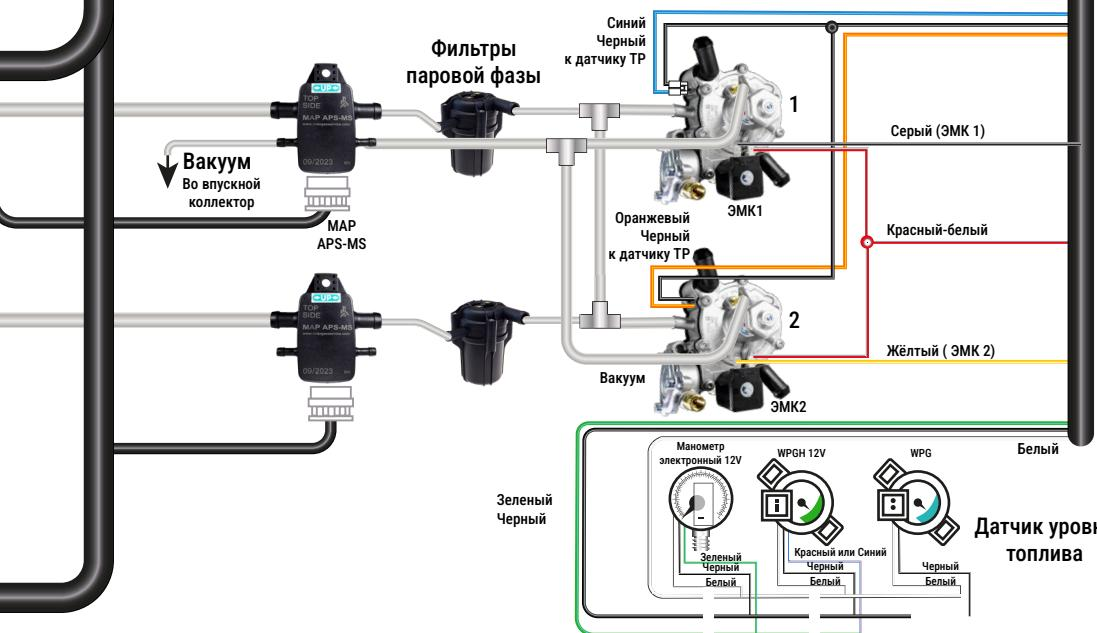
**МОНТАЖНАЯ СХЕМА ALPHA MS-8-V8. 2 Редуктора**
